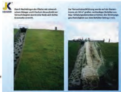
1:1 Modellüberströmungsversuch der Firma KRISMER in Zusammenarbeit mit der BOKU, Wien, 2009 und der TU Wien 2012
